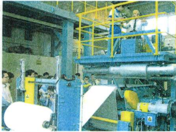
導入された不織布製造機(写真はいずれもいの町波川の県立紙産業技術センター)
